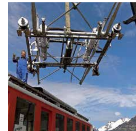
Montage des Stromabnehmers auf TW 6
